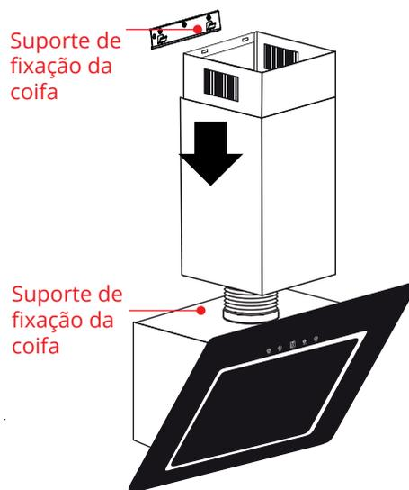
Encaixe a coifa nos ganchos do suporte de fixação instalado na parede.
