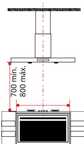
A coifa deve ser instalada numa parede plana e vertical. Verifique se a parede de instalação é resistente para suportar o peso da coifa. Paredes laterais ou armários devem estar a uma distância mínima de 60 mm da coifa; Marque o centro do cooktop, fogão ou rangetop e faça uma linha vertical até o teto, para a fixação e alinhamento do suporte;
