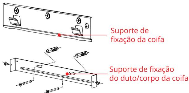
Instale o tubo de exaustão fixando-o na de saída de ar com a braçadeira plástica e o duto na Coifa; Fixe o suporte no duto externo e certifique-se de que o duto interno e o tubo de extensão possam ser instalados na altura livremente;
