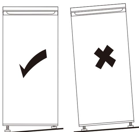
O piso deve estar nivelado. Ajustar o nivelamento adequado por um ou mais dos pés ajustáveis que ficam na base do gabinete.
