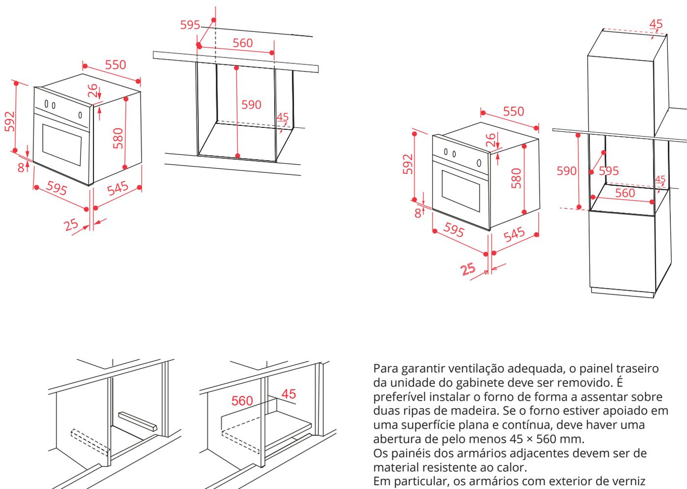
Para garantir ventilação adequada, o painel traseiro da unidade do gabinete deve ser removido. É preferível instalar o forno de forma a assentar sobre duas ripas de madeira. Se o forno estiver apoiado em uma superfície plana e contínua, deve haver uma abertura de pelo menos 45 × 560 mm. Os painéis dos armários adjacentes devem ser de material resistente ao calor. Em particular, os armários com exterior de verniz devem ser montados com colas com que possam suportar temperaturas de até 100° C.
