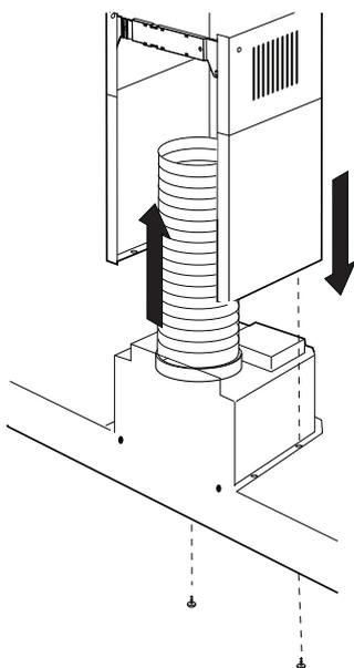
Instale o tubo de exaustão fixando-o na de saída de ar com a braçadeira plástica.
