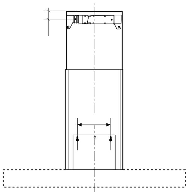
Faça 3 furos de Ø8 mm utilizando o suporte de fixação da coifa como guia e com a altura de instalação acertada, mantenha-o nivelado e insira as buchas nos furos.
