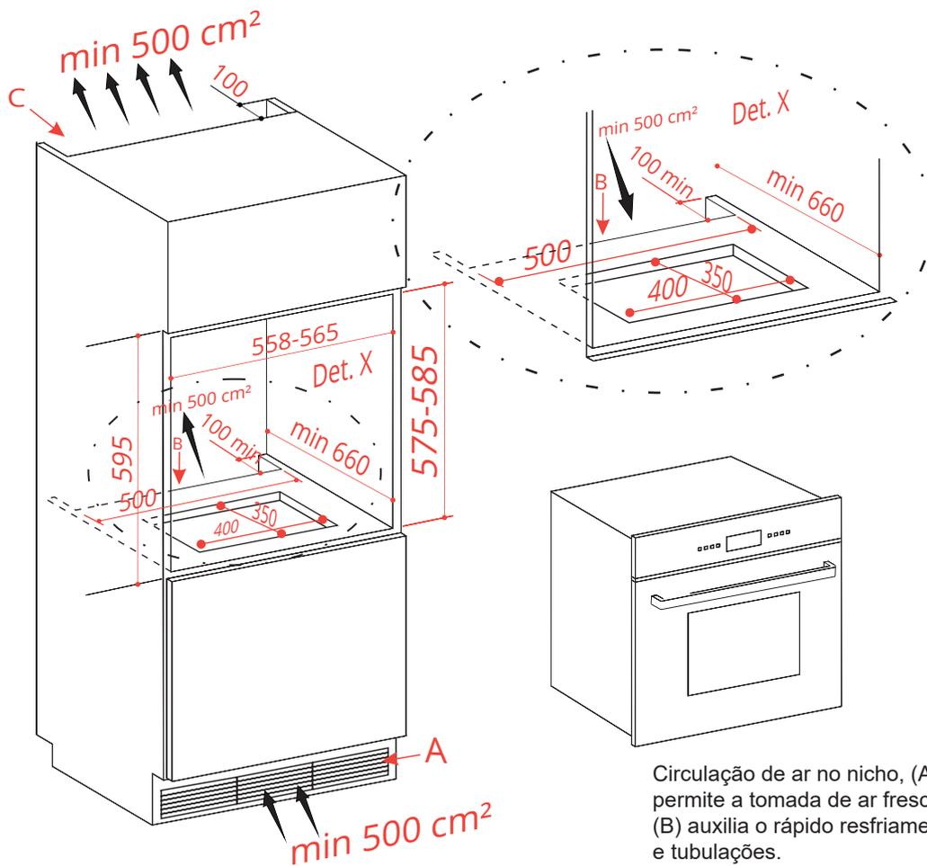
Circulação de ar no nicho, (A) na base permite a tomada de ar fresco frontal, (B) auxilia o rápido resfriamento da fição e tubulações.
