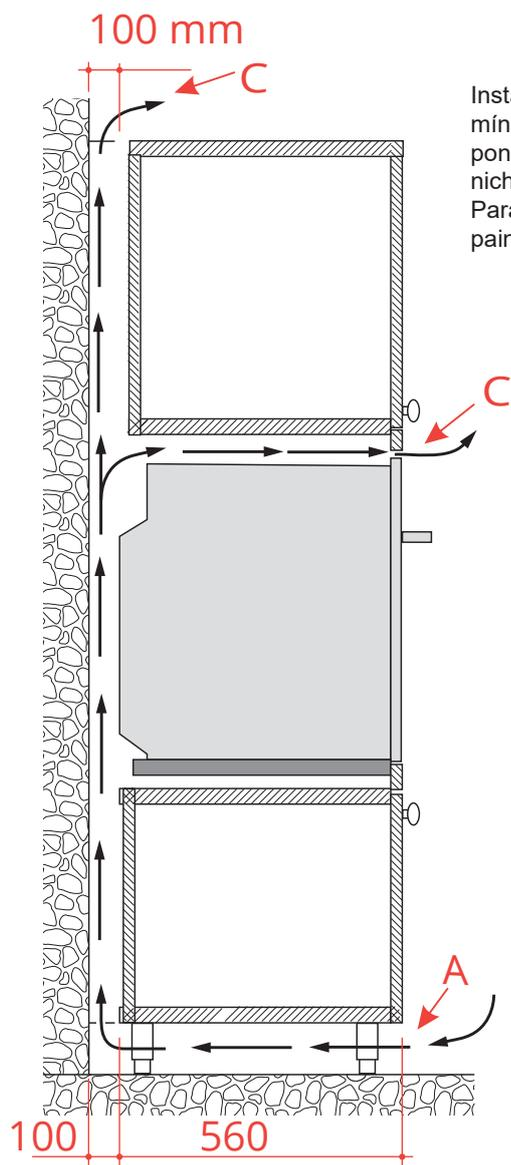
Instale o ponto de conexão elétrica numa posição, no mínimo, 150 mm afastado do fundo do Forno. Não instale o ponto de conexão elétrica (caixa de disjuntores) dentro do nicho de embutimento, localize-o em um local acessível. Para assegurar a ventilação adequada, deve ser removido o painel traseiro do nicho.
