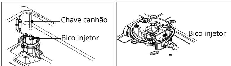
Depois de fazer as referidas substituições, o técnico deverá realizar o ajuste dos queimadores conforme descrito acima, lacrar os eventuais dispositivos de ajustes ou pré-regulação e aplicar no produto, em substituição ao existente, a etiqueta que corresponde à nova regulação do gás efetuada no produto. Esta etiqueta encontra-se no envelope dos injetores de substituição.
