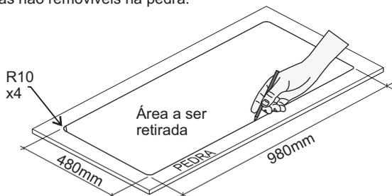
A dimensão do corte com os recuos nas partes frontal e dos fundos da pedra, onde são instalados os metais, saboneteira e outros, deverão seguir as dimensões mínimas conforme desenho abaixo.
