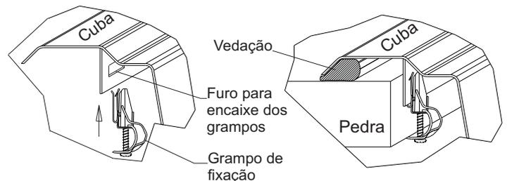
Para uma correta fixação da cuba utilize todos os grampos, conforme indicado neste manual.
