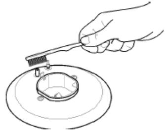
Limpeza do espalhador – Para limpeza do espalhador utilizar água morna e sabão. Após secar bem e posicioná-lo corretamente sobre o queimador.
